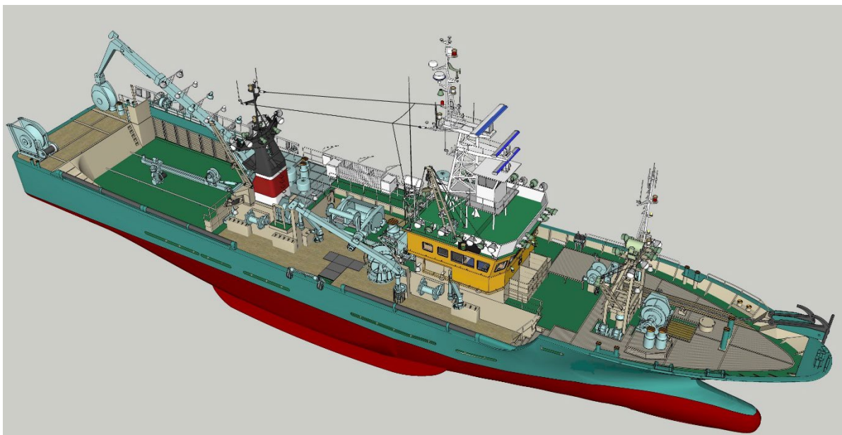
図 2-17 199 トン型まき網漁船図面
