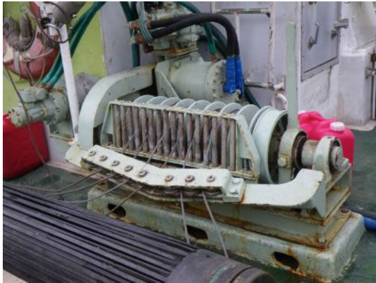
図 2-39 多段式巻き上げウインチと向竹
