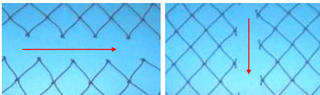
ず あみじ つな かた ひだり つ みぎ わきせつ あ 図13 網地の繋ぎ方：左 はな継ぎ、右 脇節合わせ
