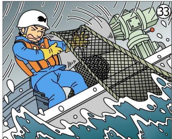
事故例 2： ネットホーラーを使用して揚網作業中、荒天で船のローリングが激しく、体のバランスを崩した時に合羽の袖口がはさまれ左手及び腕部をネットホーラーにはさまれた。③③
