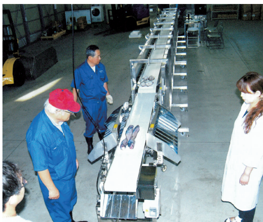
図2 3段階の全自動選別検査 (出典：「高度衛生管理型魚市場いしのまき」より)
