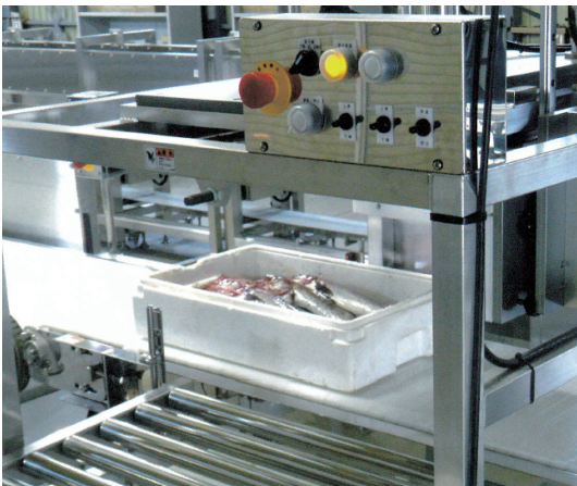
図3 魚入り発泡容器を直接コンベアに載せるだけの簡単測定 (出典:「高度衛生管理型魚市場いしのまき」より)
