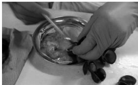
写真2 検査用のシジミの可食部分け取り （ヘラを使って2枚の貝殻を開く）
